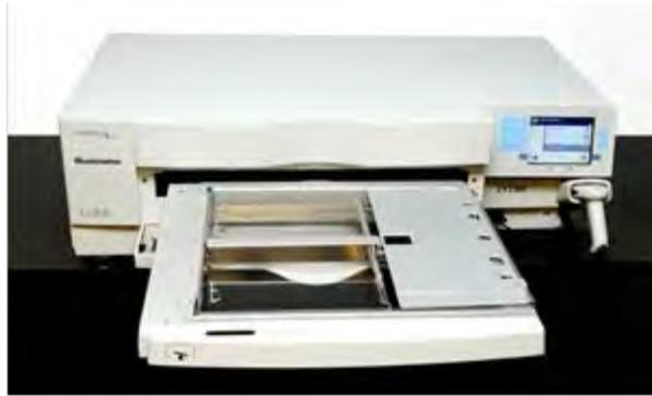
7. Abra la cubierta de la bandeja deslizando el cierre negro hacia la derecha.
